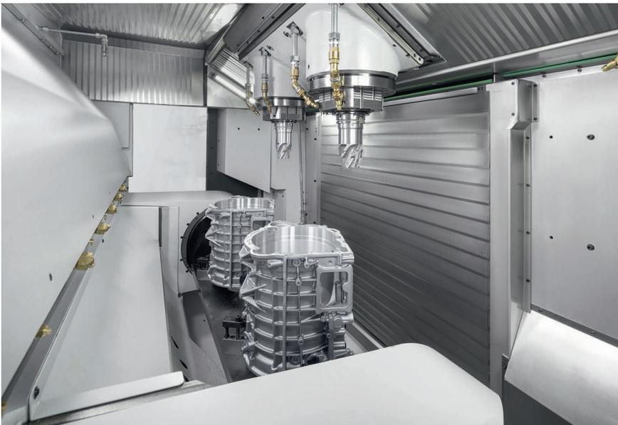
1 Highlight zur AMB: Die 'DZ 22 W five axis' im Livebetrieb, eine Zukunftsmaschine für komplexe Bauteile für E-Mobility und Aerospace © Chiron Group
