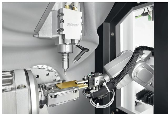
2 Plug-and-Play-Lösung für automatisierte Mikrobearbeitung: die 'Micro5', kombiniert mit dem Handlingsystem 'Feed5'
